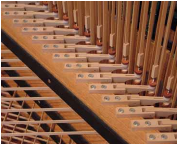
Umlenkungen der mechanischen Tontraktur, der Verbindung zwischen Klaviatur und Tonventil
